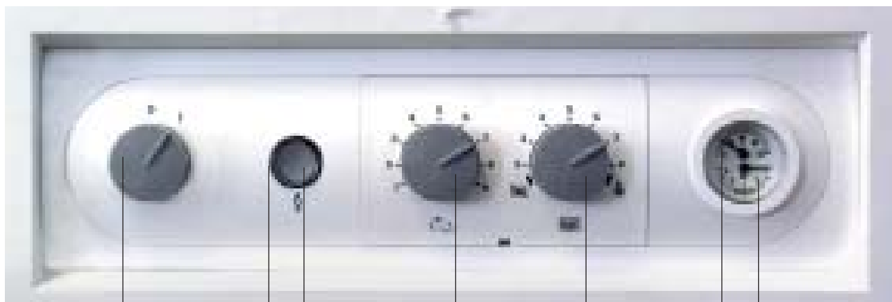
Рабочий выключатель вкл/выкл Кнопка защиты от помех Светящееся кольцо Выбор температуры нагрева воды Выбор температуры горячей воды Термометр Манометр
