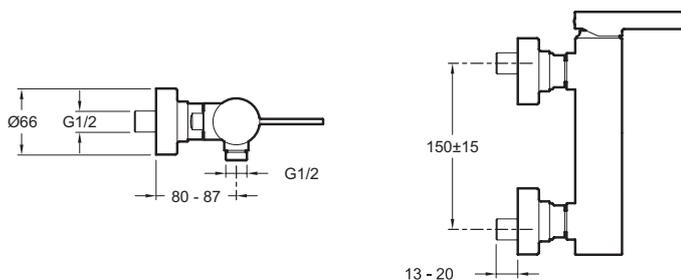
Спецификация продукта: Настенный смеситель для душа. E12779-4. Коллекция: STILLNESS. Вес: 3 кг. Расход воды: 14 л/мин при давлении 3 бар. Механизм: Последовательный керамический картридж.
