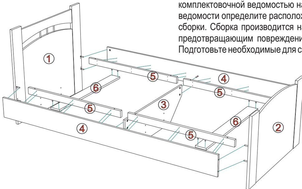
**Сборка:** Шурупами 3\*16 поз.13 закрепите наконечники поз.10 к нижним торцам спинки головной поз.1, спинки ножной поз.2 и стенки вертикальной поз.3. Шурупами 4\*35 поз.14 соедините стенки вертикальные поз.5 с царгами поз.4. Эксцентриковой стяжкой (дюбель ввинчиваемый поз.12, дюбель концевой поз.17 и эксцентрик поз.15) и шкантами 8\*30 поз.11 соедините царги поз.4 со спинками головной поз.1, ножной поз.2 и стенкой вертикальной поз.3.
