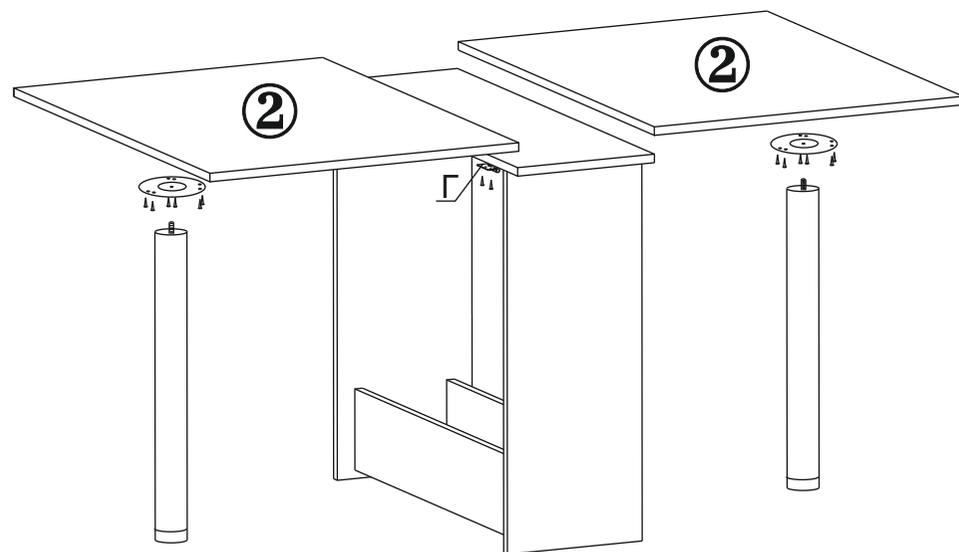
3.2. К тыльной стороне дополнительных столешниц (дет.№2) шурупами 4x16 прикрутите опорные площадки для крепления металлических опор.
