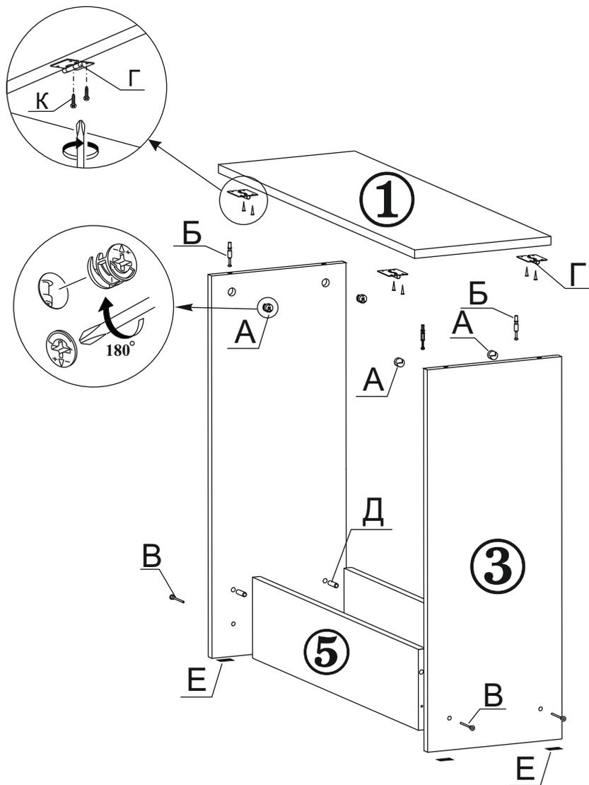
3.1. В отверстия на столешнице (дет.№1) закрутите штоки эксцентриков (поз.Б), шурупами 4x16 закрепите картонные петли (поз.Г).
