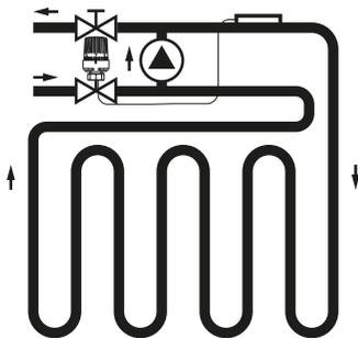
Используйте термостатическую головку M30x1,5 с накладным датчиком на подающем коллекторе для защиты системы от перегрева. Головкой следует доукомплектовать самостоятельно.
